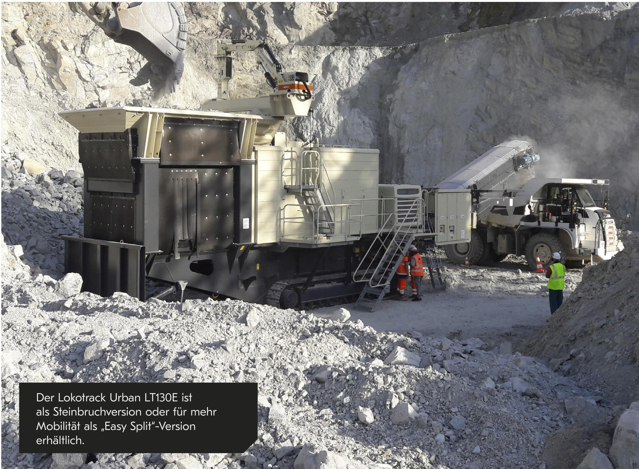
Der Lokotrack Urban LT130E ist als Steinbruchversion oder für mehr Mobilität als „Easy Split“-Version erhältlich.
