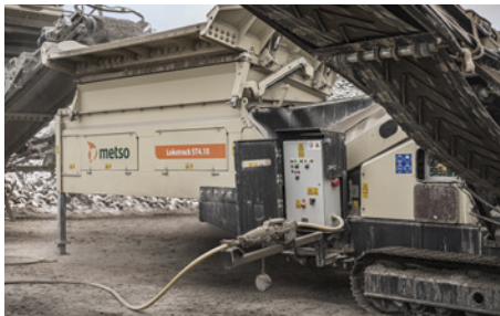
e-Power für effizienten Diesel-Elektro-Hybridbetrieb.
