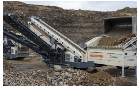
Großer Aufgabebunker ermöglicht einen geschlossenen Kreislauf.
